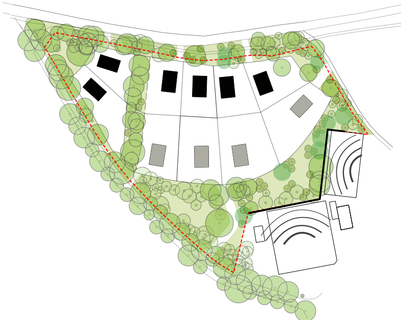
geluidsreductie door plaatsing van schermen langs de tennisvelden
